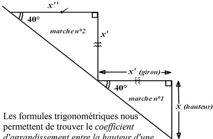
Les formules trigonométriques nous permettent de trouver le *coefficient d'agrandissement* entre la hauteur d'une marche et son giron.
